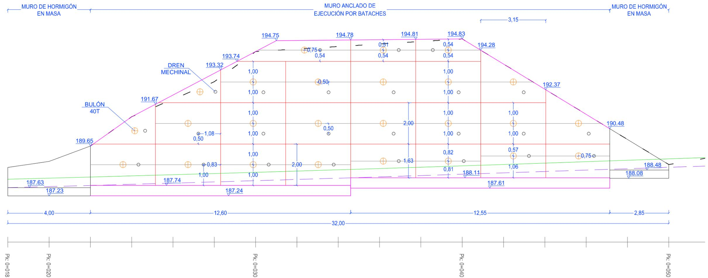
NOTA: Las cotas del Perfil Corresponden con la altimetría de alta precisión NAP, lo que implica una diferencia de cotas de -0.40 con respecto al taquimétrico.
